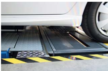
Beim Einfahren werden Reifenprofiltiefe und der Abrieb automatisch gemessen.
