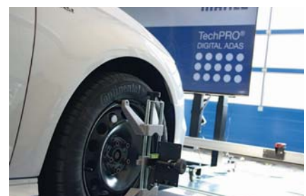
Das System von Mahle zur Kalibrierung von Kameras und Sensoren kommt ohne Tafeln aus.
