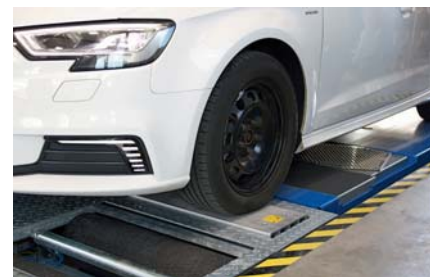
Nächste Station: Vor dem Bremsencheck werden noch die Stoßdämpfer getestet.
