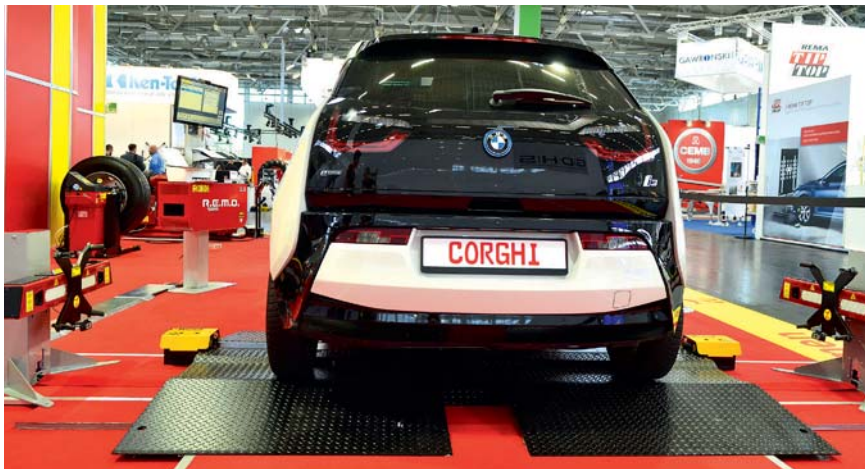
Das Fahrwerkvermessungssystem Remo Rapide von Corghi lässt sich unter anderem mit einer Reifenprofilertiefenmessung, Scheinwerfereinstellung und TPMS-Kontrolle kombinieren.
