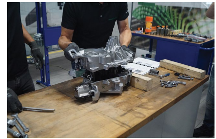
Die Distanzscheiben der Getriebewellen sollten nicht aus dem Gehäuse herausfallen.
