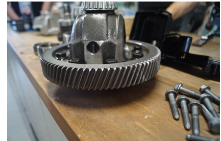
Auch der Zustand der Getriebezahnräder sollte genau inspiziert werden.
