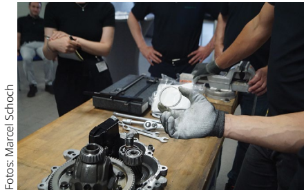
Die alten Distanzscheiben sind das Richtmaß für die Neu-Ausdistanzierung.
