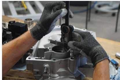
Lagersitze und die Lager müssen nach dem Austausch genau vermessen werden.
