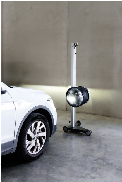
Capelec CAP2700: Digitale Scheinwerfermessung mit Inklinometer-Kompensation.
