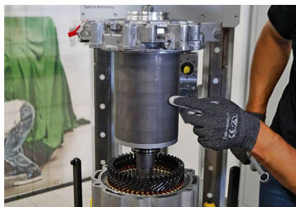
An den Rotor darf kein Schmutz geraten, die Magnetkräfte ziehen metallische Späne an.
