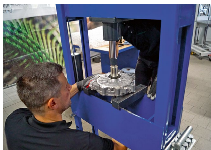
Einfache Technik: Das Aus- und Einpressen der Wälzlager ist eine Routinearbeit.
