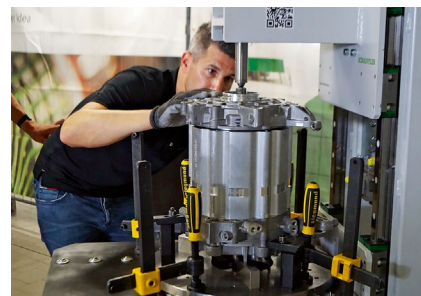
Nach dem Ausrichten des Stators kann der Rotor in den Stator eingeführt werden.
