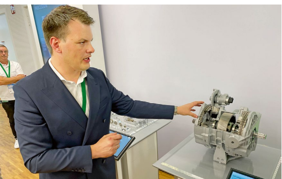
Die Lamellenbremse an der Hinterachse soll ohne Emissionen zuverlässig bremsen.
