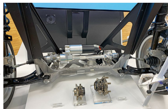
Schaeffler bezeichnet seine Steer-by-Wire-Lösung als „Road Wheel Actuator“.
