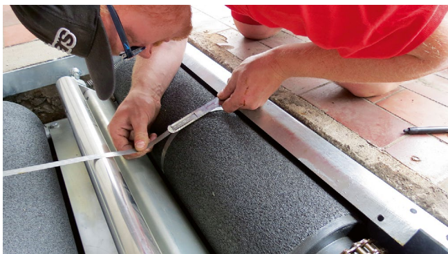
Sorgfalt ist gefragt: Die beiden hinteren Bremsrollen werden jeweils in der Mitte und seitlich vermessen.
