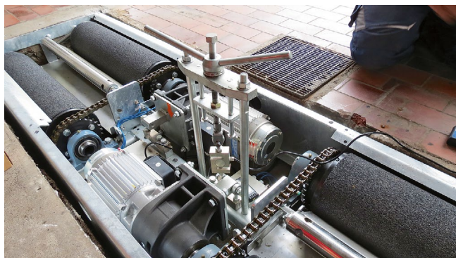
Die hersteller-spezifische Kalibriervorrichtung wird mit dem Rahmen des Bremsprüfstandes verschraubt.
