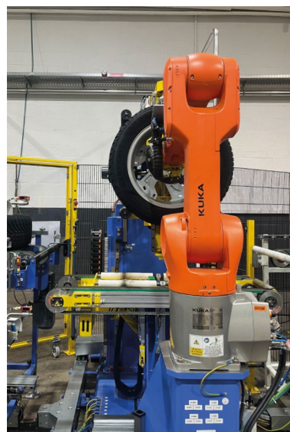
Automatische Montageanlage für Reifen von RR Team in Lissendorf
