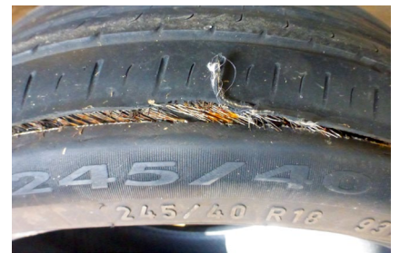
Bei diesem Reifen hat sich die Flanke wie mit dem Messer getrennt vom Profil gelöst.
