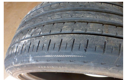
Die Innenseite ist wegen falschen Reifendrucks und Sturzes stark abradert.
