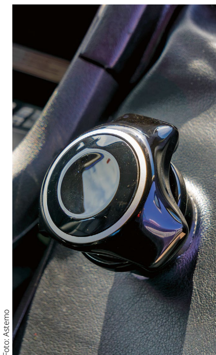
Knauf statt Lenkrad: Das innovative „New Input Device“ (NID) von Astemo.
