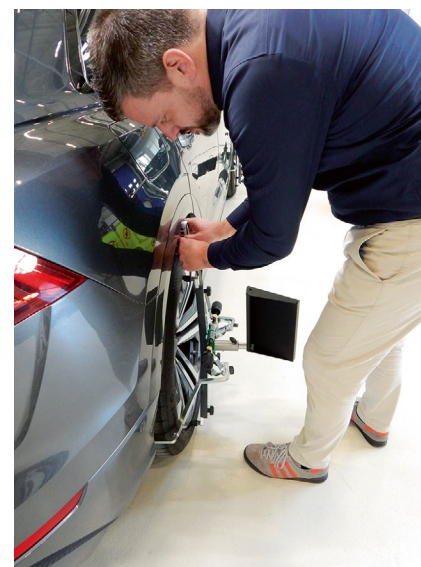
Mario Maas misst nach Anbringung der Radklammern mittels Laser die Radhaushöhe.
