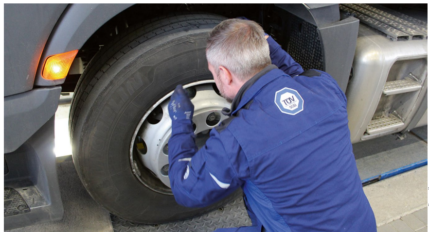
Auch Brems scheiben, -trommeln oder die Radnabe können zu Ungleichgewichten führen.
