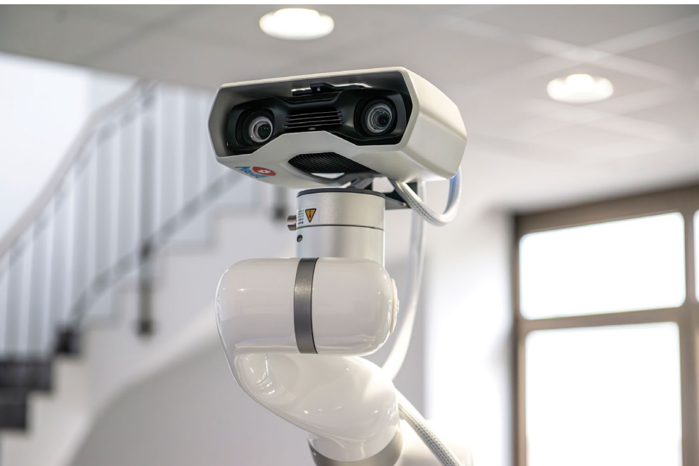
Der Sechs-Achs-System-Roboterarm von MAIA mit anpassbarer Aufnahme kann sich in allen Raumebenen bewegen.
