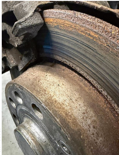
Foto: FabuCar Fast am gesamten Fahrzeug sitzen die Bremssättel fest, nur ein Rad ist freigängig.
