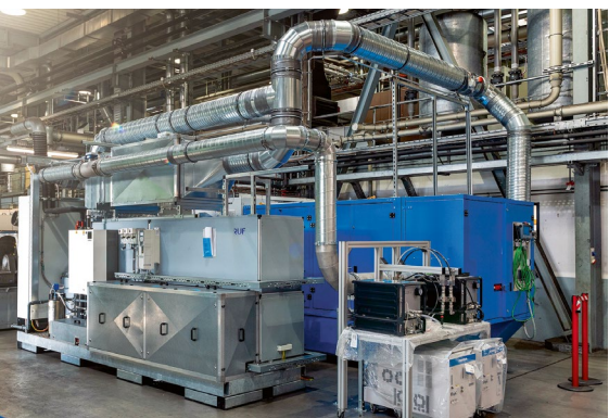
Die Feinstaubemissionen von Bremsen werden auf einem Prüfstand ermittelt.
