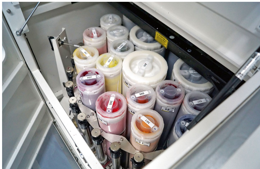
„ColorMatchic“ nimmt in drei Karussells 96 Toner/Farbkartuschen auf. Je Karussell können 28 Kanister mit je 1,2 Liter und 4 Kanister mit je 4,3 Liter individuell bestückt werden.
