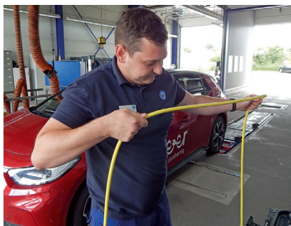
... und Kabel auf äußere Beschädigungen und Anzeichen von Überlastung.
