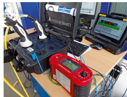
Der Messkoffer (l.) dient als Adapter zwischen Kabel und Installationstester (r.).
