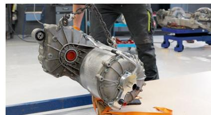
Eine wiederaufbereitete Drive Unit von SEG Automotive für das Tesla Model S.
