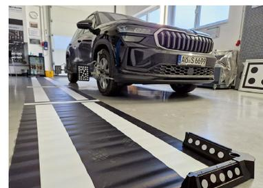
**Ausrichtungshilfe für die Vinylteppiche zur Kalibrierung der 360-Grad-Kamera**
