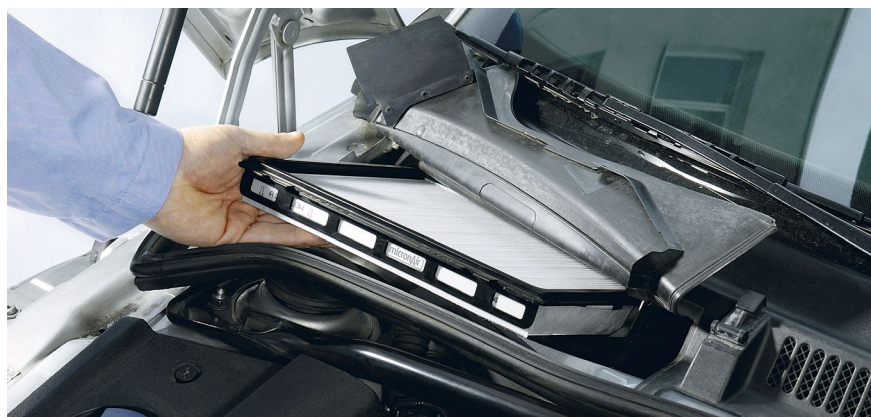
Der Innenraumfilter besteht aus vliesartigem Material und fängt Grobes ab.
