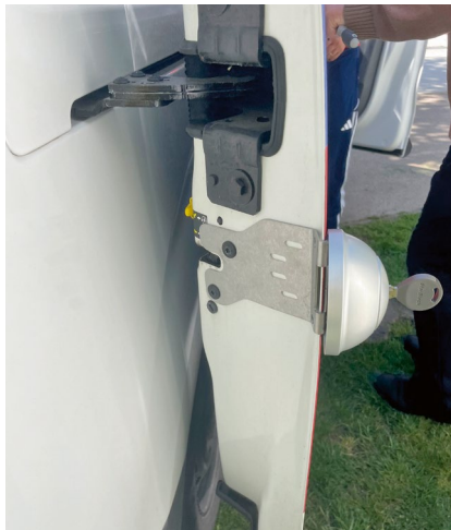
Lieferwagentüren lassen sich mit dem Cargoblock-System nachträglich sichern.
