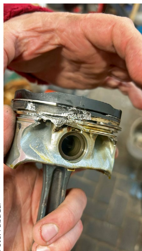
Die Verbrennungsaussetzer haben am Kolben deutliche Spuren hinterlassen.
