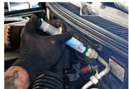
Mit Kraft muss das Dichtmittel in den Niederdruckkreislauf bei laufender Klimaanlage gedrückt werden.
