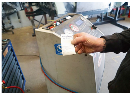
Der Ausdruck aus dem Klimaservicegerät belegt, dass gut 200 Gramm Kältemittel in vier Wochen verloren gegangen sind.
