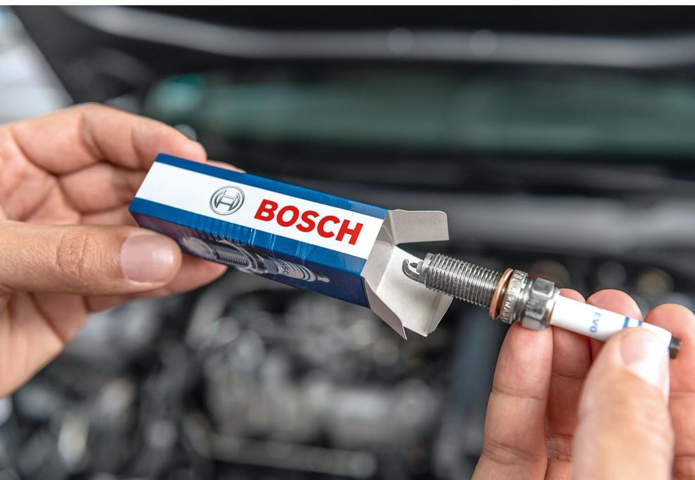
Zündkerzen halten Spannungen bis 45.000 Volt und mehr über 100.000 Kilometer aus.
