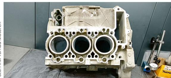
Zylinderlaufbuchsen helfen dabei, die Original-Kolben verwenden zu können.
