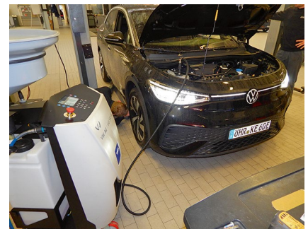
Das VAS 531 011 ist ein Servicegerät für die Wartung des Kühlsystems in E-Fahrzeugen.
