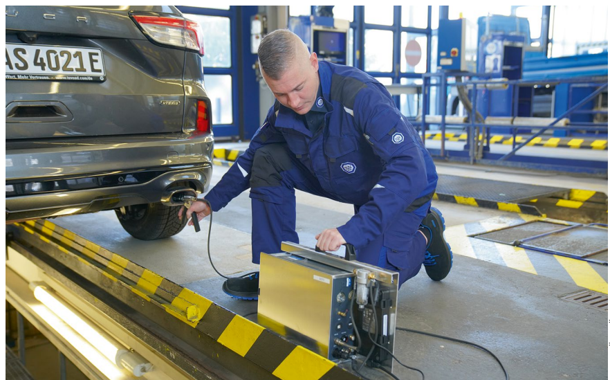
Mit der Partikelmessung werden defekte Abgasreinigungs-Systeme sicher entdeckt.
