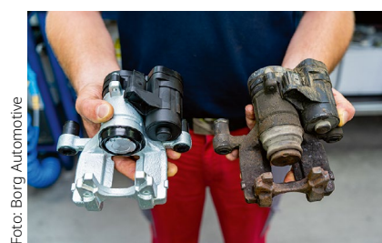
Aus Alt mach Neu: ein wiederaufbereiteter Bremssattel.
