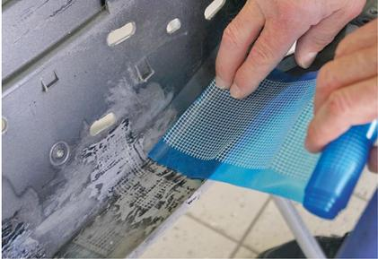
**Zur Verstärkung der Bruchstelle kann an der Rückseite ein Netz aufgebracht werden.**
