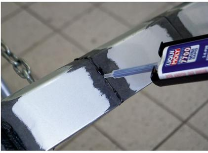
**Besserer Halt durch einen V-förmigen Spalt, in den der Klebstoff eingefüllt wird.**
