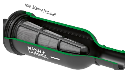
Der Coolant-Clean-Filter scheidet Partikel in der Batterie-Kühlflüssigkeit von E-Autos ab.
