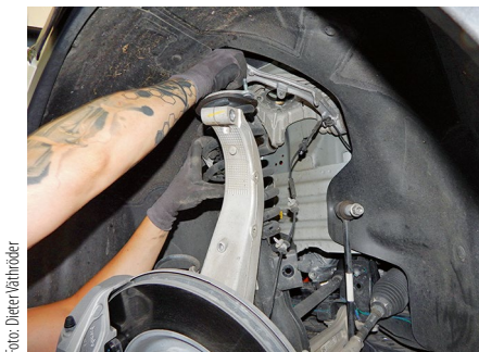
Der Ausbau der Federn und Federbeine unterscheidet sich nicht von anderen Fahrzeugen.
