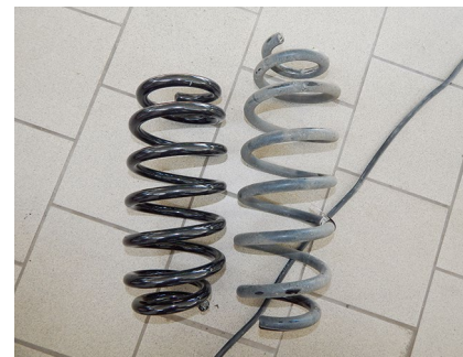
Deutlich ist der Unterschied zwischen Serienfeder (l.) und dem Tuning-Produkt zu sehen.
