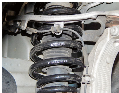
Die neuen Federn legen den Tesla Model Y um drei Zentimeter tiefer.
