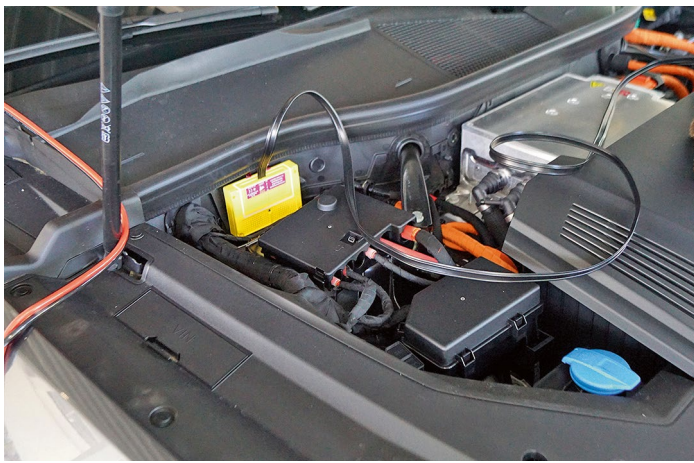
Die Kontaktplatten werden mit Kabelbindern befestigt. Das Kombigerät Stop&Go 8 Plus-Minus Clip braucht keine Verbindung zur Karosserie.
