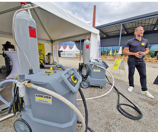
Trockeneisreiniger: Das CO 2 kommt aus der Flasche, die Trockeneis-Lagerung entfällt.
