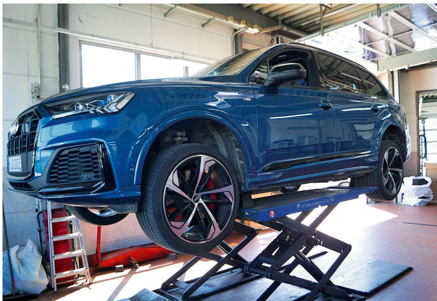
Plug-in-Hybride sind sehr schwer. Gummiklötze müssen daher besonders robust sein.
