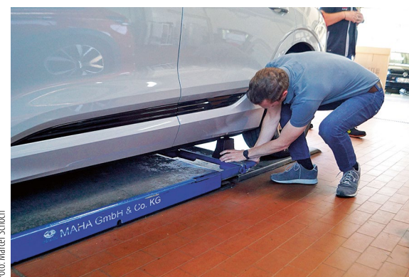
Zum sicheren Anheben müssen die Gummiebeklötze exakt ausgerichtet sein.
