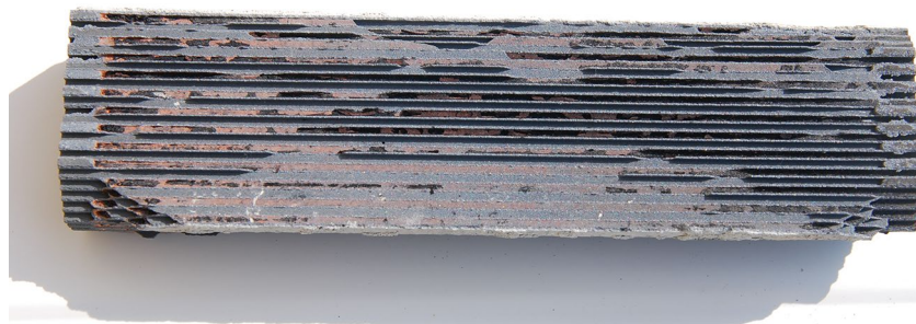
Bei diesem zugesetzten Partikelfilter sind deutlich die verstopften Kanäle erkennbar.
