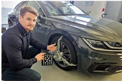
**Anbringen der Radklammern mit Targets an allen 4 Rädern.**
