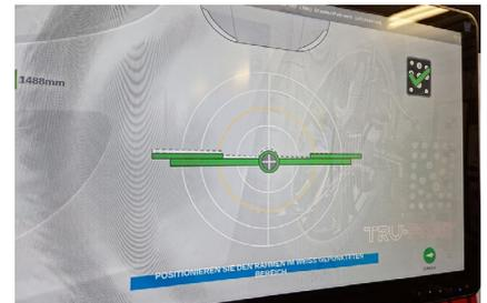
**Korrekte Justage des Rahmens unterstützt durch farbige Anzeige.**
