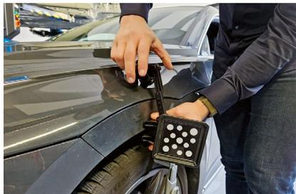
**Erfassen der korrekten Höhe mittels Höhenstands-Targets an allen vier Rädern.**
