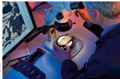
Im Labor werden die neuen Belagmischungen genau unter die Lupe genommen.
