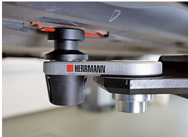
Der Formschluss des Wechselaufsatzes sorgt für Sicherheit.
