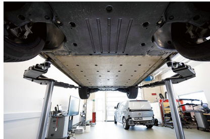
Im angehobenen Zustand freier Zugang zur Batterie.
