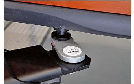
Push-Funktion: Exakte Positionierung des Aufnahmetellers unter dem Fahrzeug.
