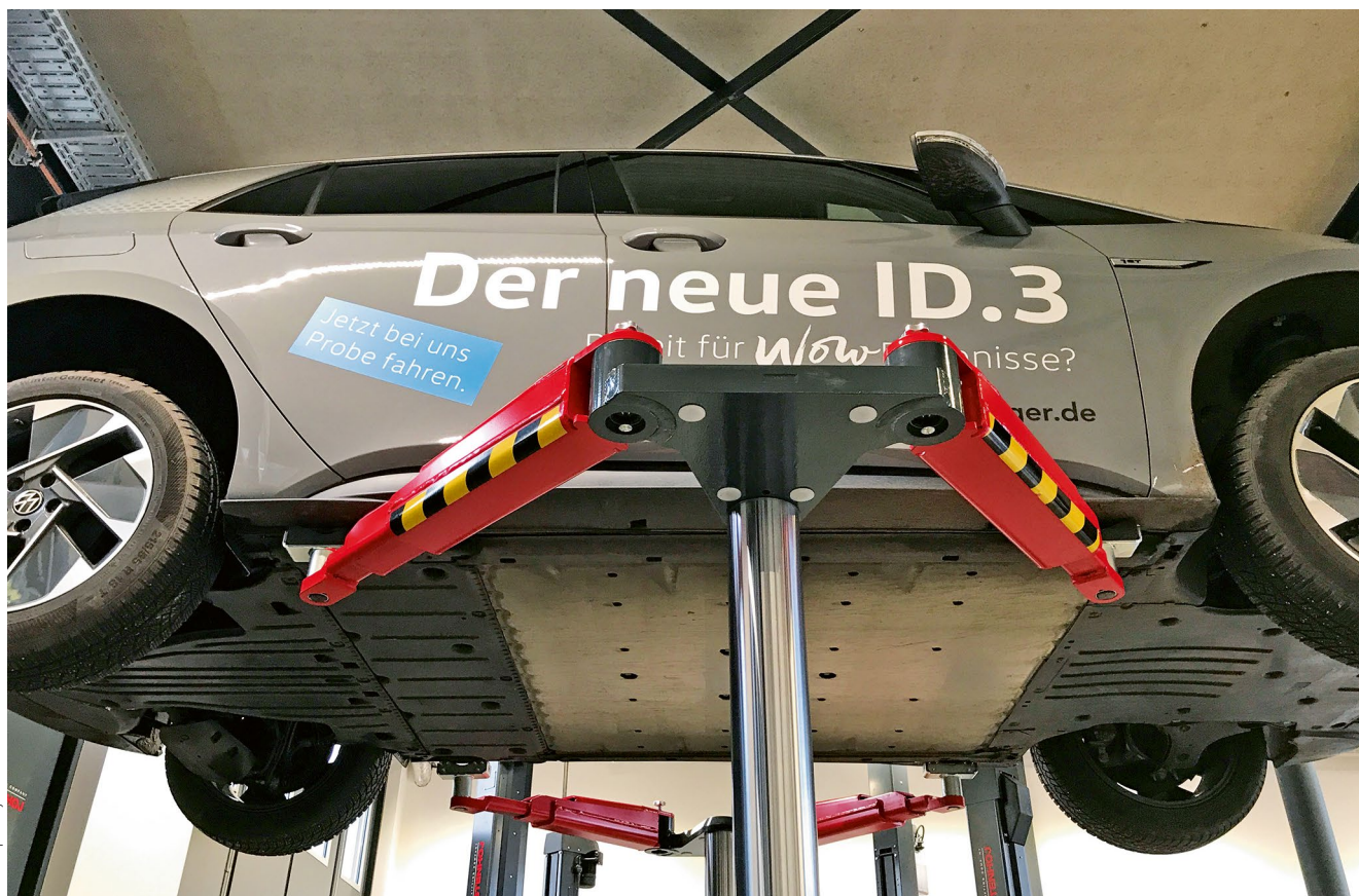
Bei Elektrofahrzeugen wandern die Aufnahmepunkte konstruktionsbedingt ganz an den Rand – beim Anheben auf der Bühne ist Vorsicht geboten.
