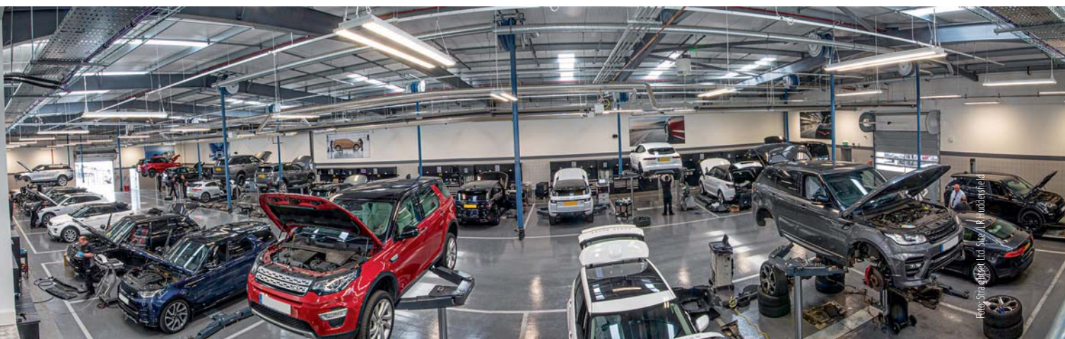
In Groß-Werkstätten sind Unterflur-Hebebühnen die erste Wahl. Der einzelne Arbeitsplatz wirkt aufgeräumt und ist optimal genutzt.
