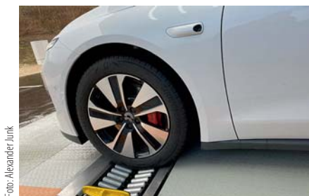
Die gelben Klammern richten das Fahrzeug automatisch korrekt in der Station aus.
