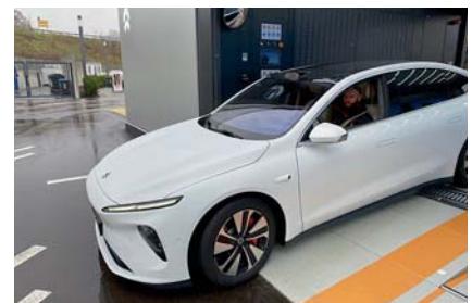
Das Auto rangiert nach Bestätigung vollautomatisch rückwärts in die Station ein.
