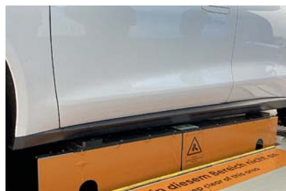
Passt die Position, wird das Fahrzeug angehoben und der Akkutauch startet.
