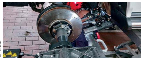
Mit dem Pro-Cut-System können Bremscheiben direkt am Fahrzeug abgedreht werden.
