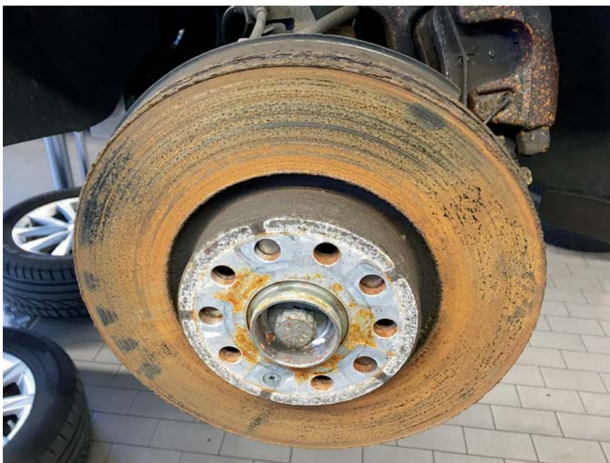
Verrostete Bremscheiben sind bei Fahrzeugen mit E-Antrieb keine Seltenheit.
