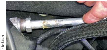
Typischer Schleifschaden an einer Klimaleitung. In Kürze wird das Rohr undicht sein.
