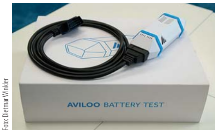
Kleines Tool, großes Potenzial: Die AVILOO-Box mit Stecker für den Batterie-Test.
