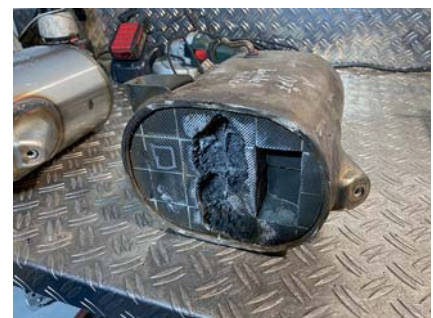
So sieht ein Partikelfilter aus, wenn er mit Reinigungs-Chemie falsch behandelt wurde.
