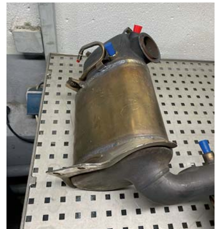
Zum Abschluss erfolgt nochmals eine Differenzdruckmessung. Das Ergebnis: 13 Millibar.
