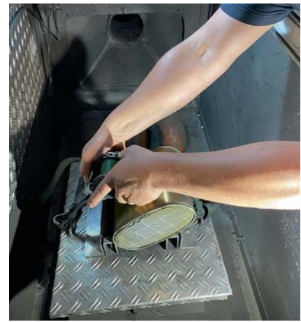
Die Reinigung geschieht per CO 2 -Schneestrahlen in der selbst konstruierten Reinigungsbox.
