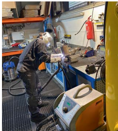
Dann wird der Filter wieder fachmännisch geschweißt und mit Anbauteilen verbunden.
