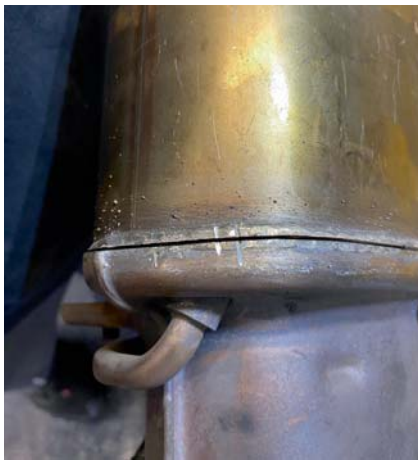
Eine gesetzte Markierung zeigt, wie sich der Filter danach wieder zusammenfügen lässt.
