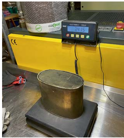
Nach dem Öffnen des Filters wird das Gewicht notiert, ebenso nach der Reinigung.
