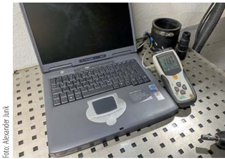
Vor dem Öffnen des Filters wird eine Messung des Differenzdrucks durchgeführt.
