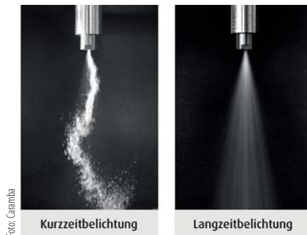
Der schwingende Strahl erzeugt denselben Sprühwinkel wie normale Flachstrahldüsen.
