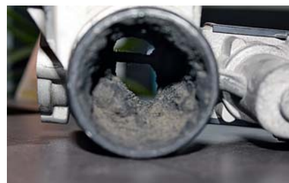
Beispiel für eine verkockte Drosselklappe und Überzeugungsgrund genug, aktiv zu werden.
