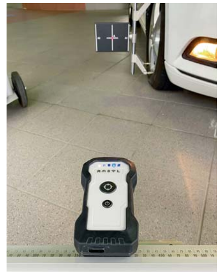
Die Werte der Abstandsmessung zum Vorderrad werden automatisch ins System übernommen.
