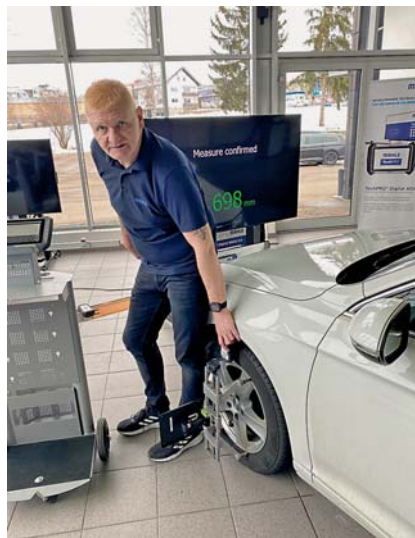
Die Höhenstandskontrolle via Laser erfolgt blitzschnell an allen vier Rädern.
