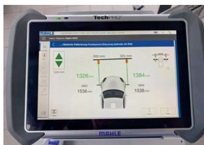
Das grüne Mess-Rechteck zeigt an, dass Fahrzeug und Kalibriermonitor korrekt stehen.
