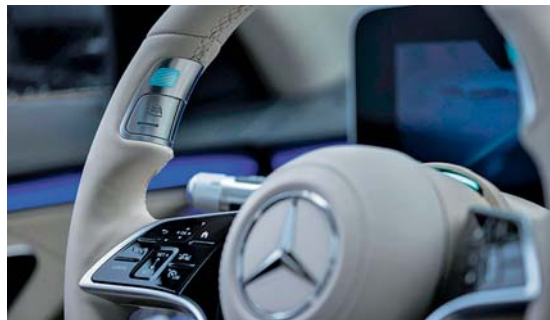
Der Drive Pilot wird über den Lenkradkranz links und rechts am Volant durch den Fahrer aktiviert.
