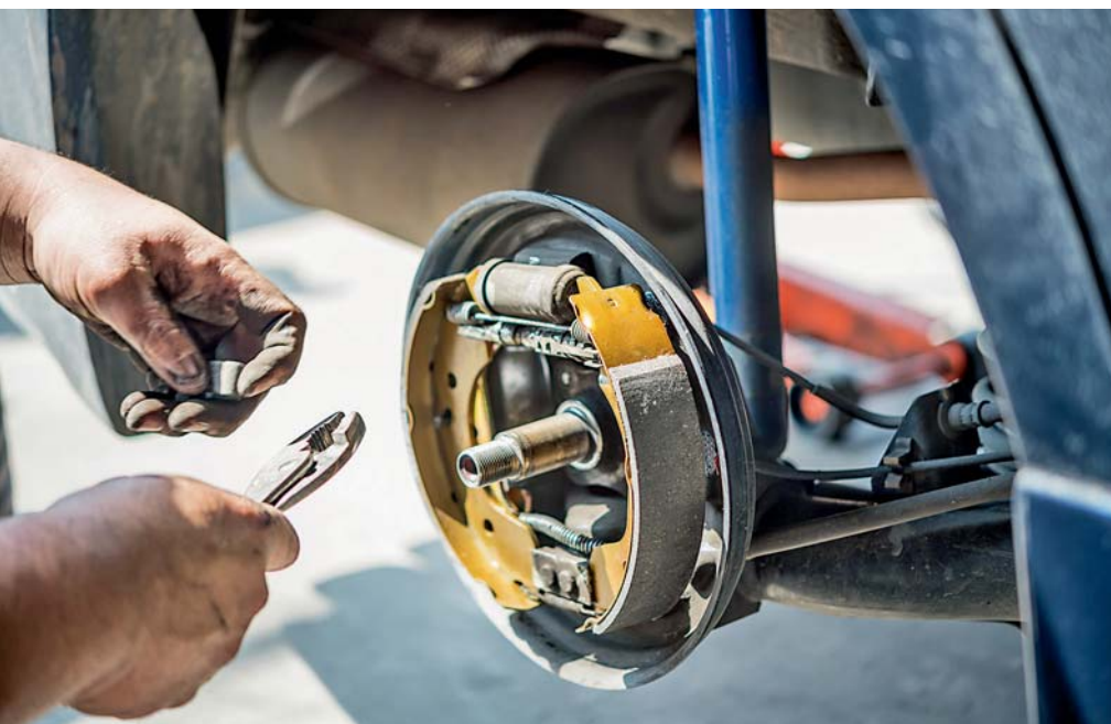
Durch das gekapselte System ist eine Trommelbremse in der Lage, Bremsstaub zurückzuhalten.
